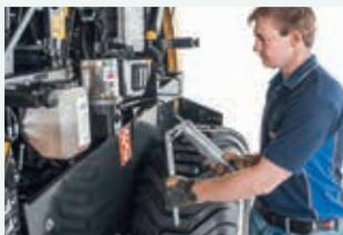
O sistema de lubrificação centralizada Lincoln é fácil de verificar e simples de atestar.
