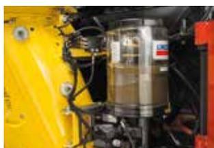
O sistema de engraxamento automático centralizado é fácil de acessar.
