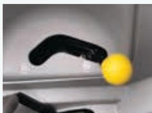
Nos modelos de cabina SynchroShuttle™, a tomada de força é eficazmente acionada por uma alavanca servo-assistida, ergonomicamente posicionada para uma atuação sem esforço.
