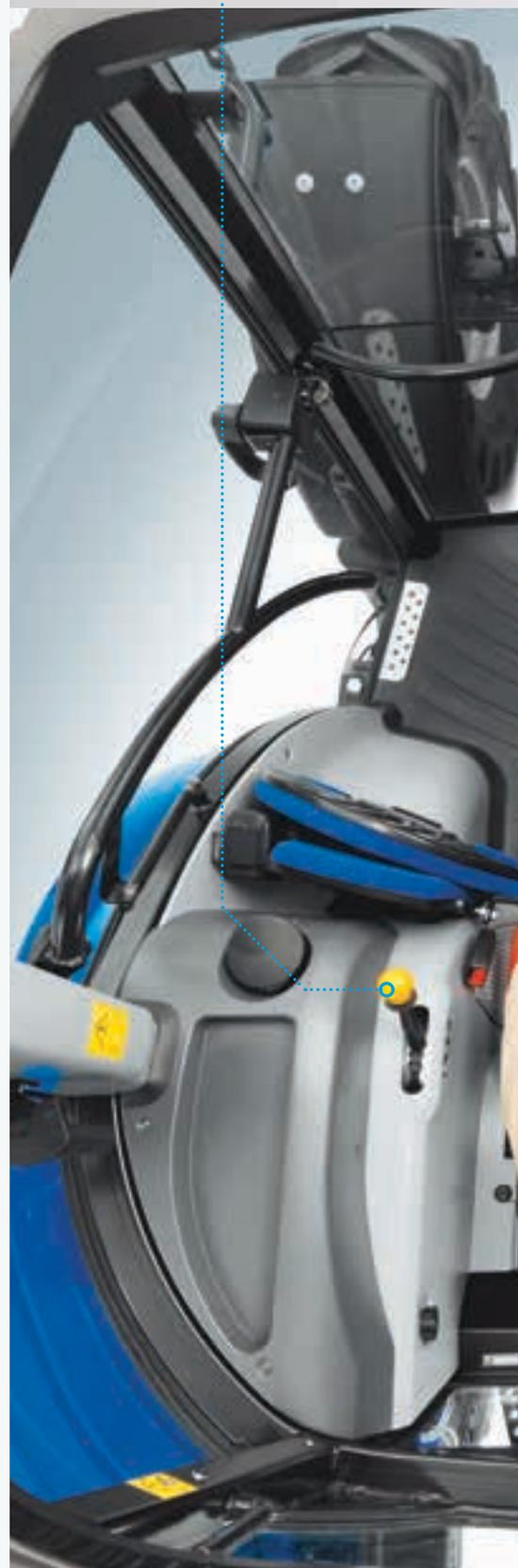
O painel de instrumentos bem visível move-se em conjunto com a coluna da direcção totalmente ajustável, o que significa que poderá ver todos os principais parâmetros de funcionamento sem qualquer obstáculo.
