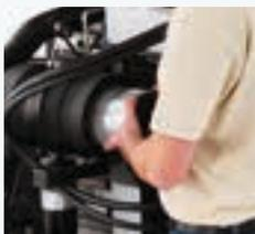
O filtro de ar do motor é fácil de verificar, limpar ou substituir, sem ser necessário utilizar ferramentas.
