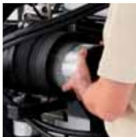
O filtro de ar do motor é fácil de verificar, limpar ou substituir, sem ser necessário utilizar ferramentas.
